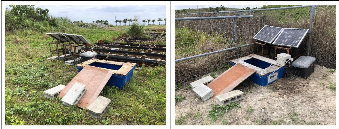
図2 音声誘因装置 (左：音声装置 A、右：音声装置 B)
