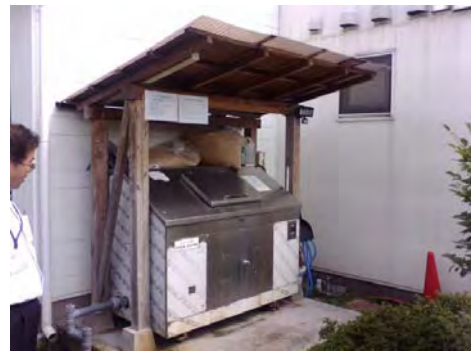
写真1 店舗に設置した食品残渣発酵分解装置
