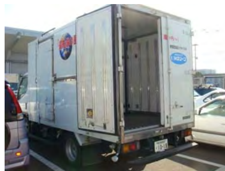
写真1 食品残さ運搬専用保冷車 (出典:平成20年度食品リサイクル推進環境大臣賞事例集)
