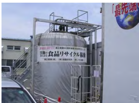
写真5 発酵槽(タンク)……駐車場に設置可能な小型装置
