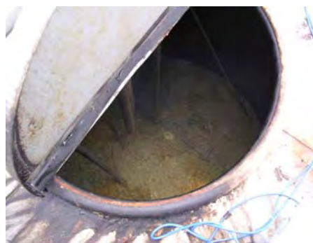
写真6 発酵槽(タンク)内部
