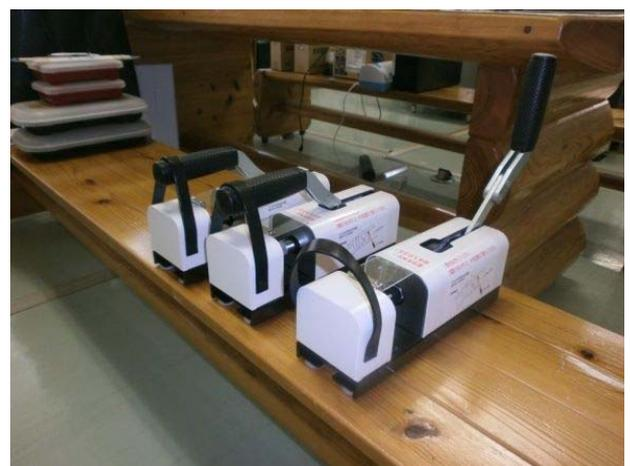
図 3-1-17 携帯電話破壊工具
