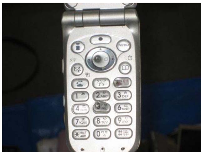
【破壊工具による物理破壊後の携帯電話】
