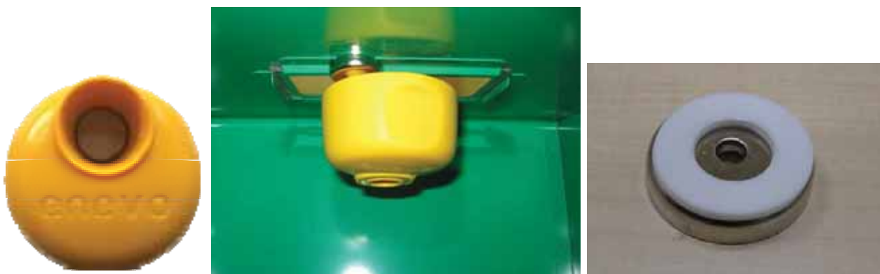
図 2-1-3 センサー（Enevo 社製 左：センサー本体、中：ボックスへの取付状況、右：取付用磁石）
