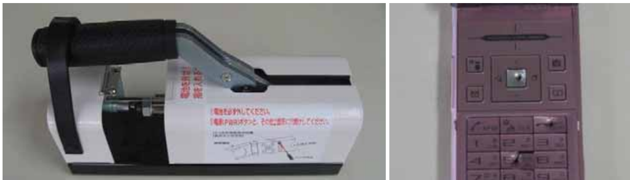
図 4-1-5 携帯電話の物理破壊（左：破壊工具、右：物理破壊後の携帯電話）
