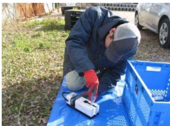
【破壊工具を用いた携帯電話の破壊の様子】
