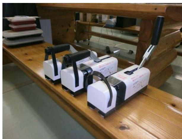
写真5 携帯電話破壊工具
