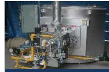
高性能工業炉 (リジエネ バーナ) (豊通マシナリー)
