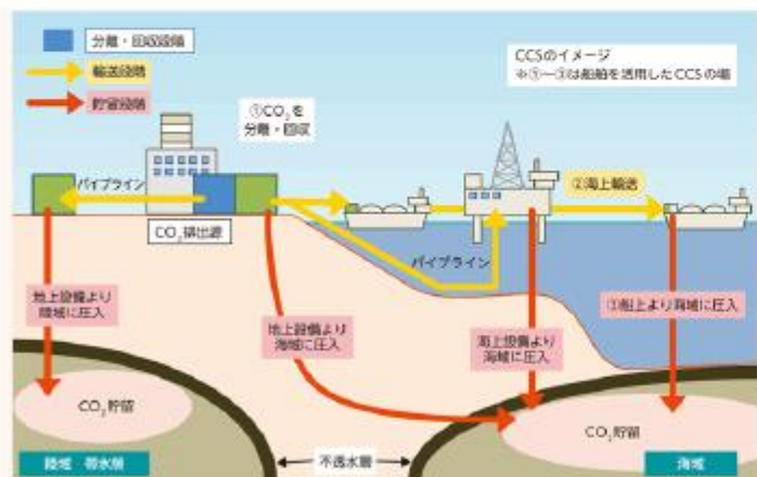
【CCSにおける分離回収から貯留までの流れ】
