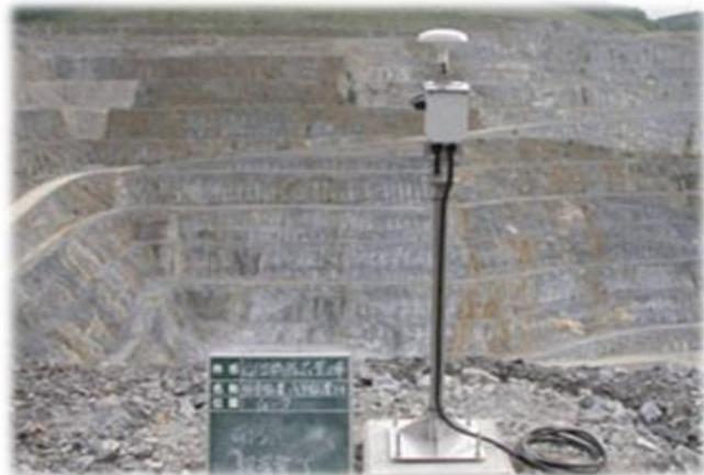
「SHAMEN-NET」は、GPS自動計測システムを用いて地盤や構造物の変位をリアルタイムに3次元・mm単位で計測し、専任技術者が計測変位を24時間365日監視する維持管理支援サービス
