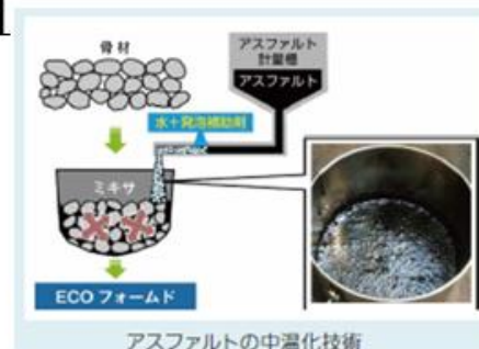
アスファルトの中温化技術
