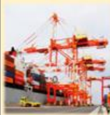
ガントリー クレーン
