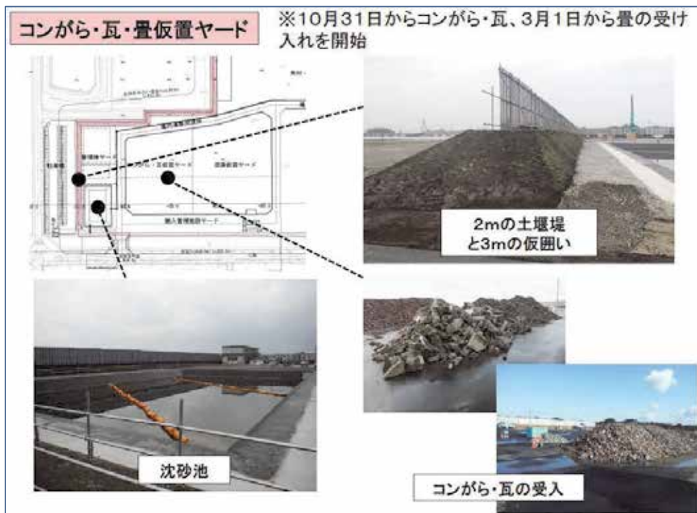
図 5.3.3 コンクリートがら・瓦・畳仮置ヤードの平面配置と設備
