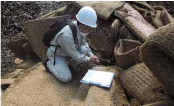
仮置廃棄物の内部温度計測状況
