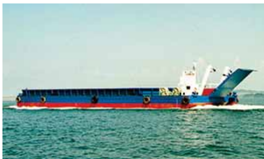
ランプウェイ台船「第一大福丸」 座波建設株式会社 所有 [日本作業船協会 HP]
