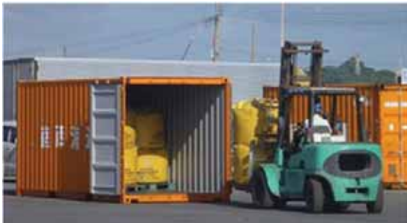
フレコンバッグを12ft コンテナに積込状況 (2段) [中城港]
