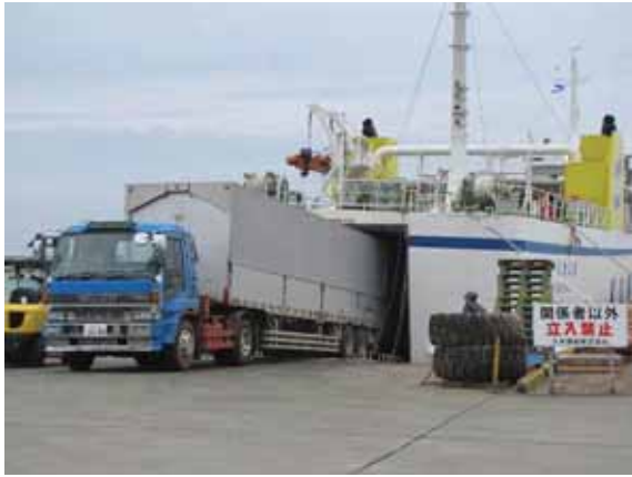
フェリー荷役の状況 自走で降りるトレーラー [兼城港] yec 撮影
