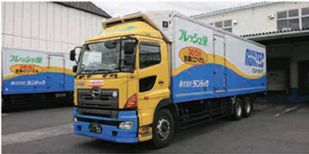
ハイブリッド電動式冷凍機を搭載した大型冷凍冷蔵トラック
