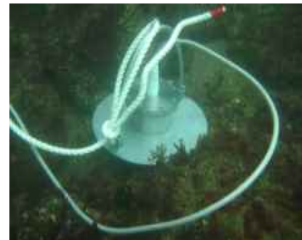
ピックアップ設置状態
