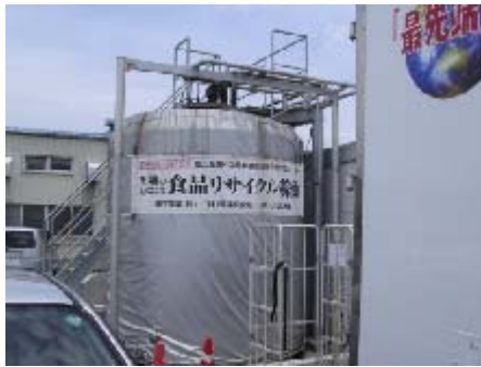
写真5 発酵槽（タンク）・・・ 駐車場に設置可能な小型装置
