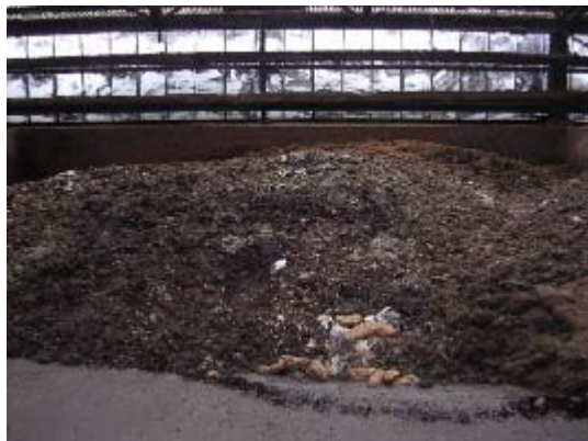
写真4 異物分離除去後の食品残さ (戻し堆肥との混合)
