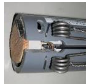
図 13. トリガー上部の隙間を厚紙で隠したワナの状態
