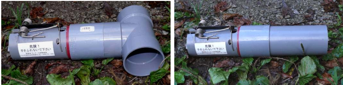
図 11. 改良型筒式ワナ (左：T 字延長ワナ 右：直線延長ワナ)
