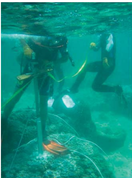
図3. 白保サンゴ礁での水中ボーリング風景。
