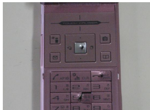
図 2-8 携帯電話の物理破壊（左：破壊工具、右：物理破壊後の携帯電話）
