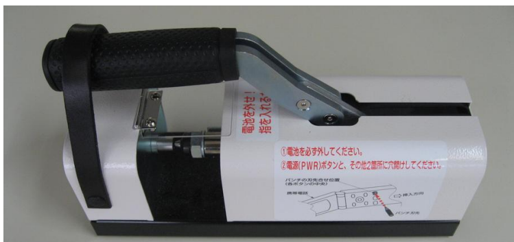
図 2-8 携帯電話の物理破壊（左：破壊工具、右：物理破壊後の携帯電話）
