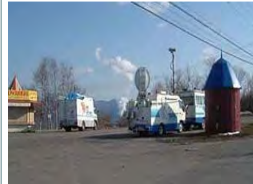
衛星通信車による火山監視（有珠山）
